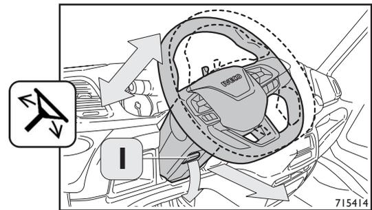
Betätigen Sie den Hebel unter dem Lenkrad, um es zu neigen oder einzustellen
